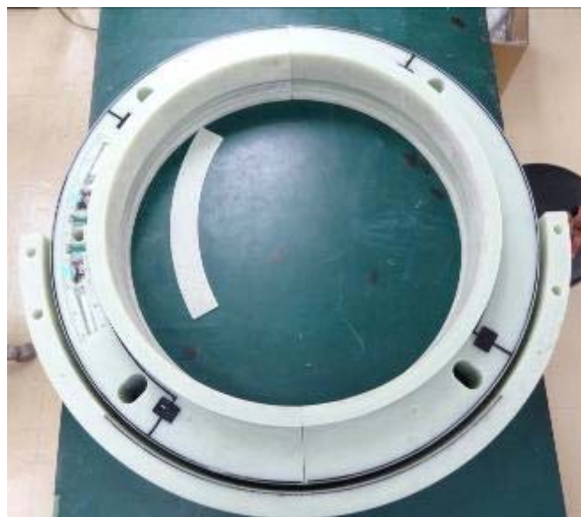
■誘導給電式ひずみテレメータ 送信機・送電コイル
