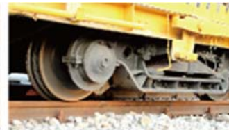
鉄道台車の輪重・横圧測定 車輪ボルト応力 ブレーキパッド温度
