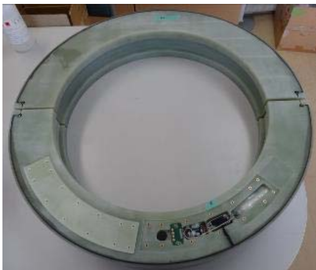
■電池式ひずみテレメータ送信機
