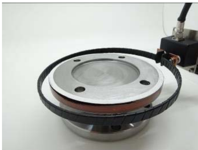
■リングアンテナ式誘導給電式温度テレメータ
